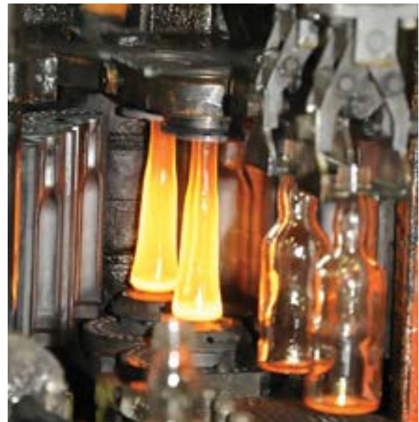
Машинско дување стакла - Параћин (фотографија из архиве Српске фабрике стакла Mechanical glass blowing - Paraćin (photo from the archives of the Serbian glass factory)
