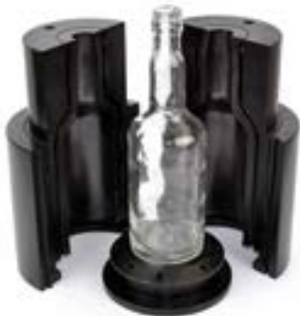
Калуп за машински дувано стакло са узорком, Српска фабрика стакла Параћин, крај 20.века, Инв. бр. Т:79.18/1 и Т:79.18/2 Mold for machine-blown glass with a pattern, Serbian glass factory Paraćin, end of the 20 th century, Inventory No. T:79.18/1 and T:79.18/2
