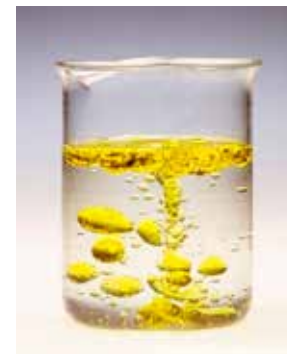
Слика 42. Раздвајање алкохола и терпентина у традиционалним конзерваторским смешама за чишћење. Интензивним мућкањем ове смеше ствара се суспензија, али се две фазе поново раздвајају након одређеног времена.
